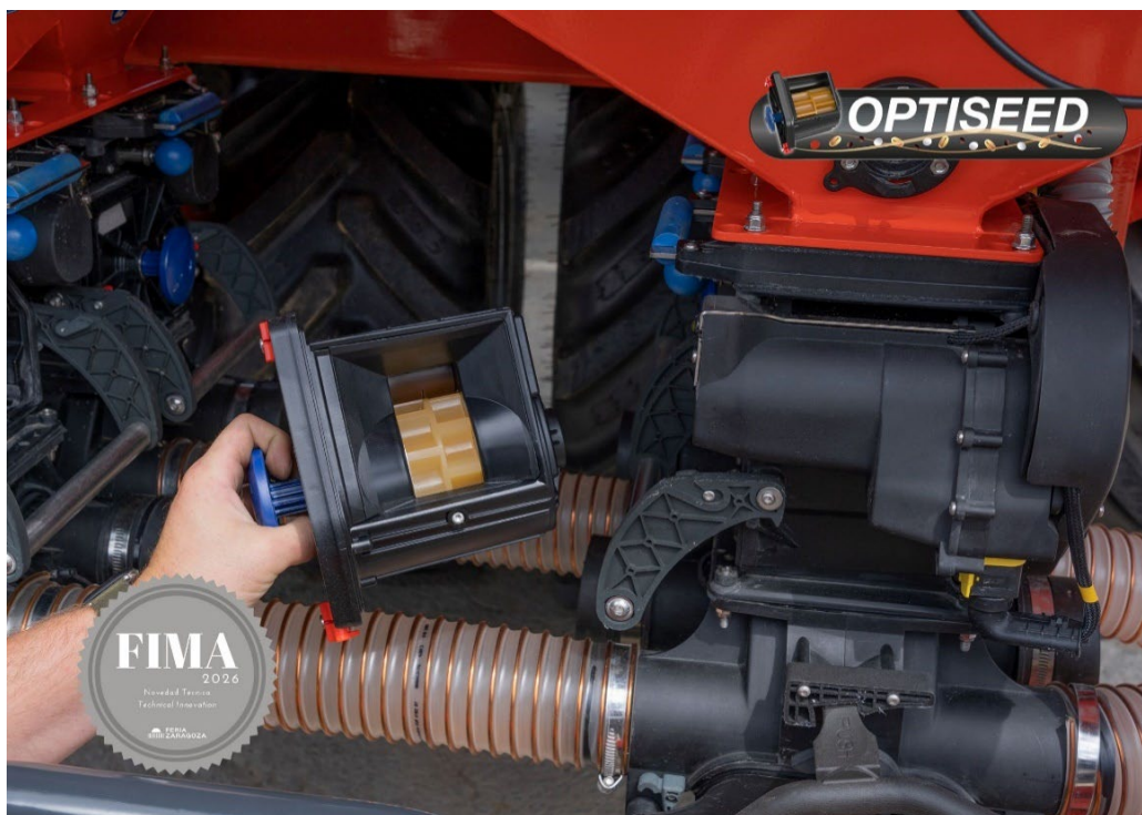
Ilustración 1. Sistema de dosificación OPTISEED de la tolva frontal TF 2300 C.
