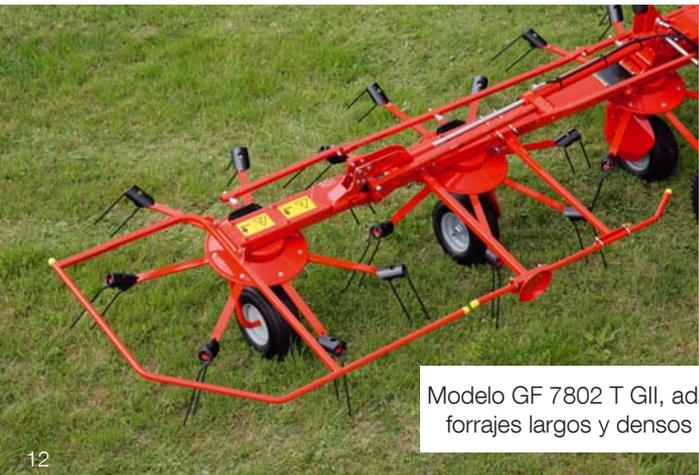
Modelo GF 7802 T GII, adaptado a la henificación de forrajes largos y densos con sus grandes rotores.
