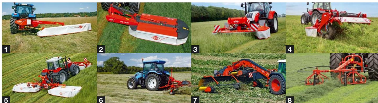
1. Segadoras de discos traseras - 2. Segadoras de tambores traseras - 3. Segadoras y segadoras-acondicionadoras frontales 4. Segadoras-acondicionadoras de discos traseras- 5. Segadoras y segadoras acondicionadoras triples - 6. Rastrillos hileradores - 7. Hileradores de tapiz - 8. Máquinas combinadas henificador/hilerador
