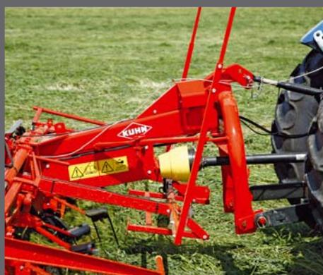
En esta posición, los rotores se centran y bloquean automáticamente, de modo que el transporte resulta rápido y seguro
