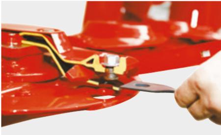
Cambio rápido de una cuchilla FAST-FIT
