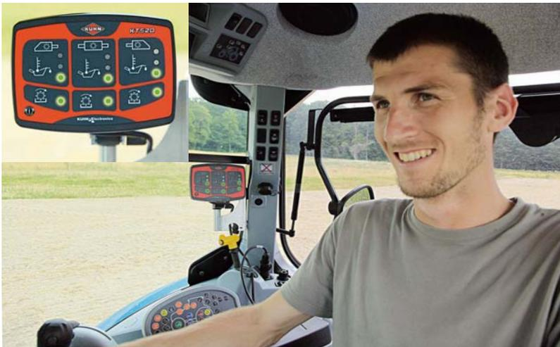
Para garantizar un uso tranquilo y el respeto de su calendario, las gradas rotativas plegables HR 1040 R vienen equipadas de serie con el terminal de control KTS 20. Instalado en la cabina, supervisa de forma continua la temperatura y la rotación de las tres cajas de cambios de la máquina. En cuanto se activan un limitador de par o un sensor de sobrecalentamiento, el conductor puede reaccionar rápidamente y asegurar que el trabajo no se interrumpa.
