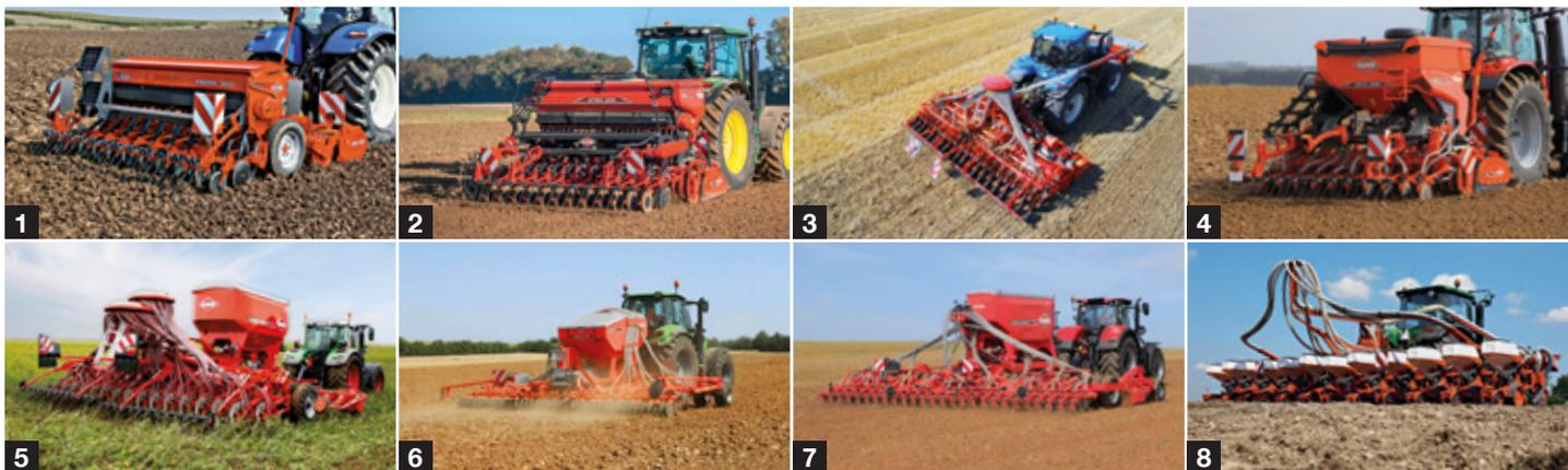
1. mecánica suspendida 2. mecánica integrada 3. con tolva frontal 4. neumática integrada 5. combinado de siembra arrastrado 6. suspendida mínimo laboreo 7. arrastrada mínimo laboreo 8. monograno
