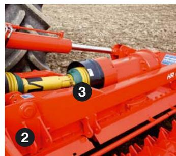
**1.** Una caja de cambios central reforzada y provista de fábrica con un sistema de circulación para refrigerar el aceite. La bomba se encuentra integrada en el cajón, de modo que la unidad resulta compacta y robusta: ningún mecanismo sensible queda expuesto a los impactos.
