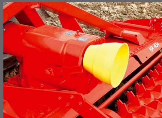
Resulta esencial que la máquina sea flexible para preparar el lecho de siembra tan intensamente como sea necesario, pero con la menor frecuencia posible. En las HR serie 104, puede escoger entre las cajas de cambios Dúplex o Múltiple.
