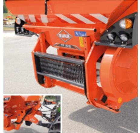
La tolva frontal también está disponible con un compactador frontal de 4 ruedas para nivelar y compactar el suelo entre las ruedas del tractor. Si no deseas compactar el suelo, opta por un chasis portador. En ambos casos pueden añadirse pesos adicionales para adaptar el equilibrio del conjunto de tractor y máquina.
