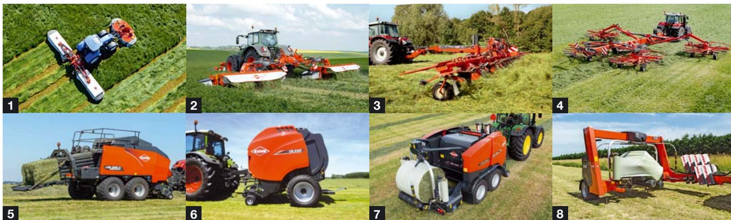
1. Segadora triple - 2. Segadora acondicionadora triple - 3. Henificador de gran anchura - 4. Hilerador de 4 rotores - 5. Empacadora de alta densidad - 6. Empacadora de pacas redondas - 7. Máquina combinada empacadora-encintadora de cámara fija - 8. Encintadora.
