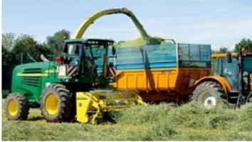
Sus aperos de cosecha pueden trabajar a mayores velocidades cuando las hileras son regulares. A velocidad constante, el conductor evita el estrés en la conducción:
