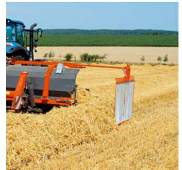
**Hileras laterales perfectamente calibradas.** Con el depósito lateral, puede añadirse bajo demanda una lona de hilerado, que contribuye a obtener una hilera calibrada, sobre todo de cara a la recogida con empacadora. En cualquier momento, el conductor puede ajustar la anchura de la hilera o plegar del todo esta lona.
