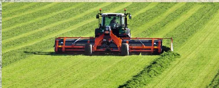
El hilerador de tapiz MERGE MAXX 950 es una máquina altamente versátil que destaca por recoger con suavidad cualquier tipo de forraje de cara a preservar al máximo su valor nutritivo. Dos pick-ups independientes ofrecen una anchura de recogida de 7,50 m en hilera sencilla y de 9,50 m en posición de «hilera central».
