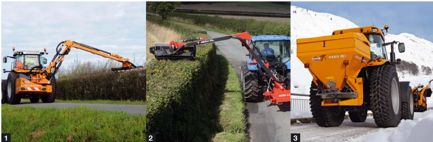
1 y 2. Segadoras desbrozadoras (a izquierda o a derecha) con un alcance horizontal de hasta 7,40 m 3. Distribuidores de sal y de arena
