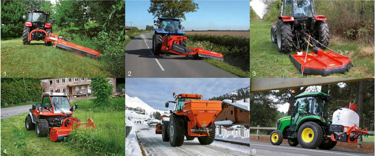
1. Trituradoras para lindes de 1,61 a 2,49 m - 2. Segadoras de arcén de 1,60 a 2,30 m en versión trasera o frontal - 3. Trituradoras especiales para microtractores y trituradoras de eje vertical - 4. Trituradoras para tractores de alta montaña de 1,75 a 2,10 m - 5. Distribuidores de sal y de arena - 6. Gama de pulverizadores para espacios verdes.
