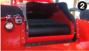
Pour augmenter le débit de chargement de cette nouvelle gamme de mélangeuses automotrices, le convoyeur de chargement a été élargi, passant de 650 à 800 mm (3). Ainsi le flux de fourrages transite plus rapidement entre la fraise et la cuve.
