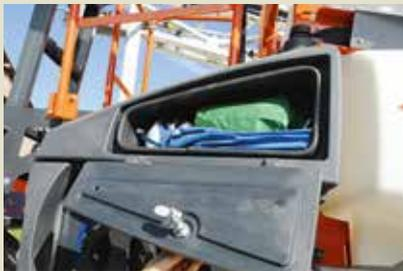
Convencidos de que es primordial trabajar junto al pulverizador en condiciones de seguridad, en el pulverizador LEXIS hemos incluido de serie dos cajas para almacenar los equipos de protección individual. Así podrá protegerse fácilmente con el equipo antes de manipular los productos fitosanitarios.
